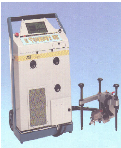
Rys.7.14. Stanowisko do wyznaczania naprężeń resztkowych na powierzchni zębów.
